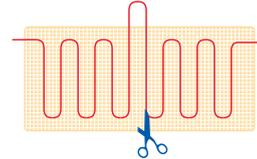
Die Heizmatten werden durch Einschneiden und Umklappen des Trägernetzes an die Stufenflächen angepasst.
